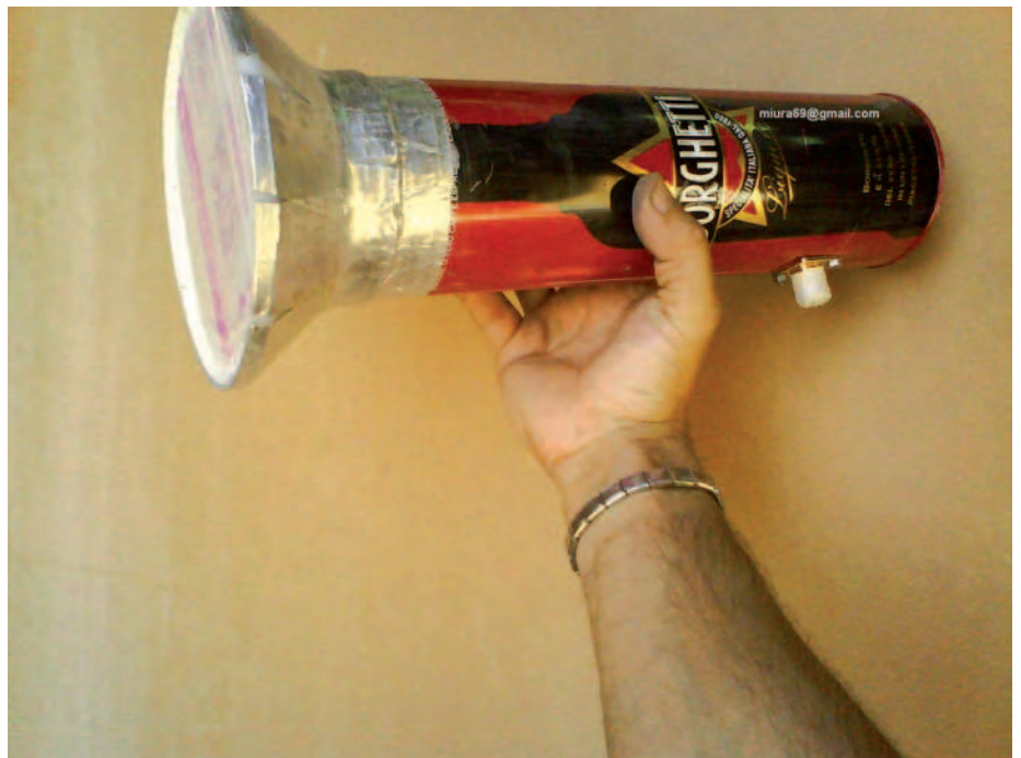
Figura 6: una cantenna in fase di realizzazione.
