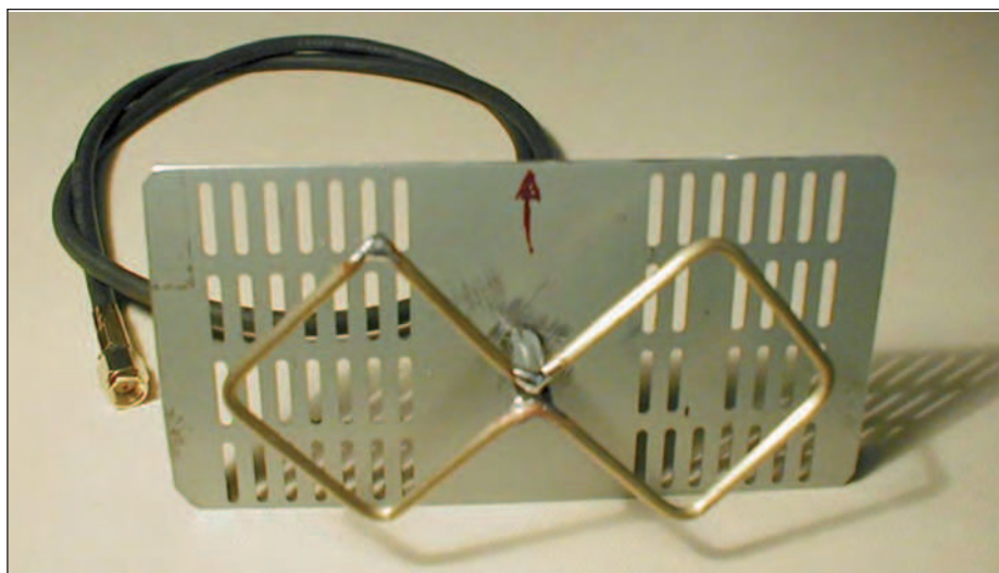
Figura 4: una biquad realizzata su un ritaglio di lamiera di ferro; l'antenna è di ottone.
