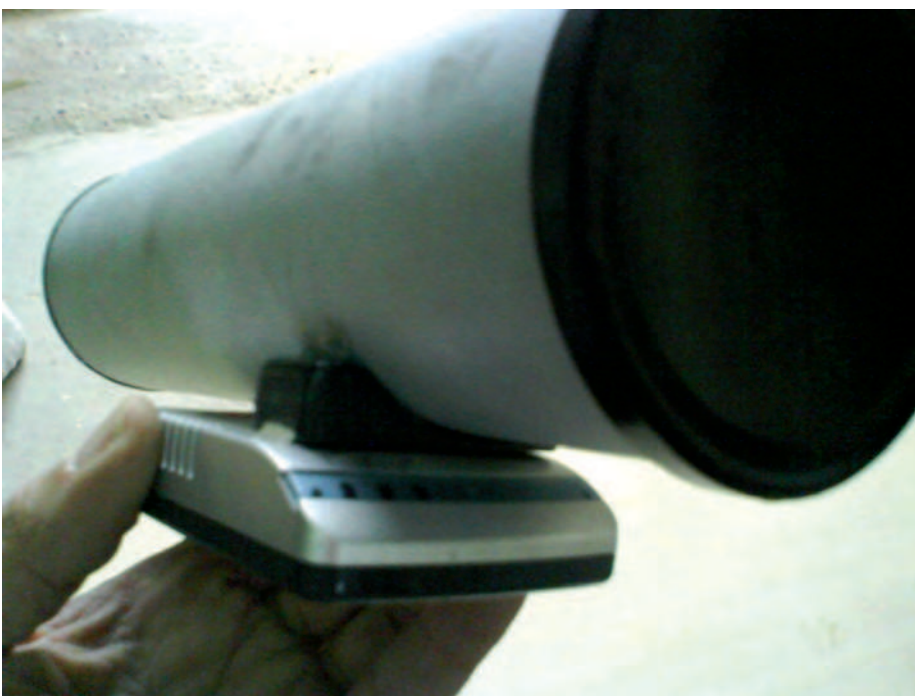
Figura 8: antenna con l'antennino del device inserito all'interno, soluzione veloce e efficace.
